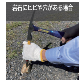
岩石にヒビや穴がある場合 タガネをその部分に差し入れ、タガネの頭にハンマーの平らな部分が当たるようにする
